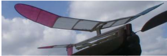
図3 高翼ライトプレーンの横滑り
